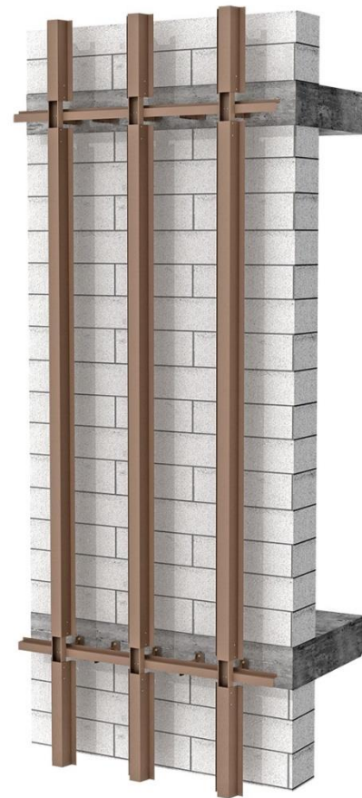
Крепление в межэтажные перекрытия
